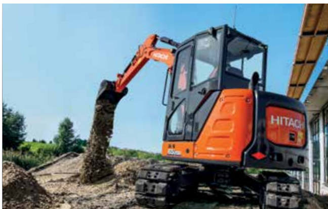
Obrotnica o skróconym tyle sprawia, że koparka ZX65USB-6 sprawdza się doskonale w miejscach, gdzie przestrzeń robocza jest ograniczona.
