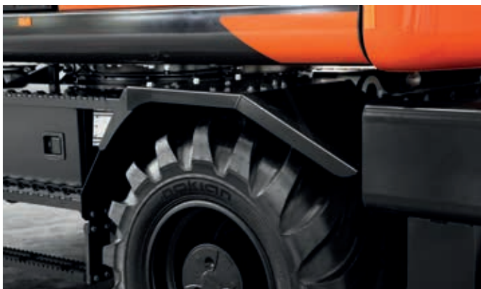
Łożyska na podwoziu chronią górną konstrukcję i światła przed zabrudzeniem, utrzymując maszynę w czystości.
