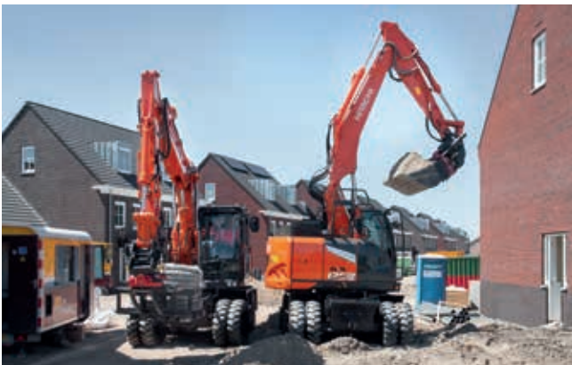
Koparka ZX135W-7 obraca się w promieniu 3,5 metra (1 740 mm do tyłu i 1 750 mm do przodu).
